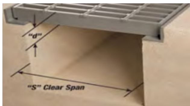
Gambar 5. Teknik Pemasangan Grating Pada Dudukan Tepi Selokan
