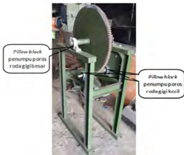
Gambar 10. Pillow Block Penumpu Poros Roda Gigi Besar dan Pillow Block Penumpu Poros Roda Gigi Kecil
