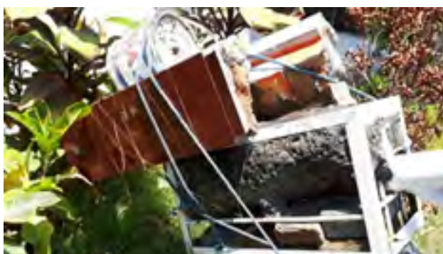
Gambar 2. Beban lebih di Bagian Pemberatnya yang Menyentuh Tanah
