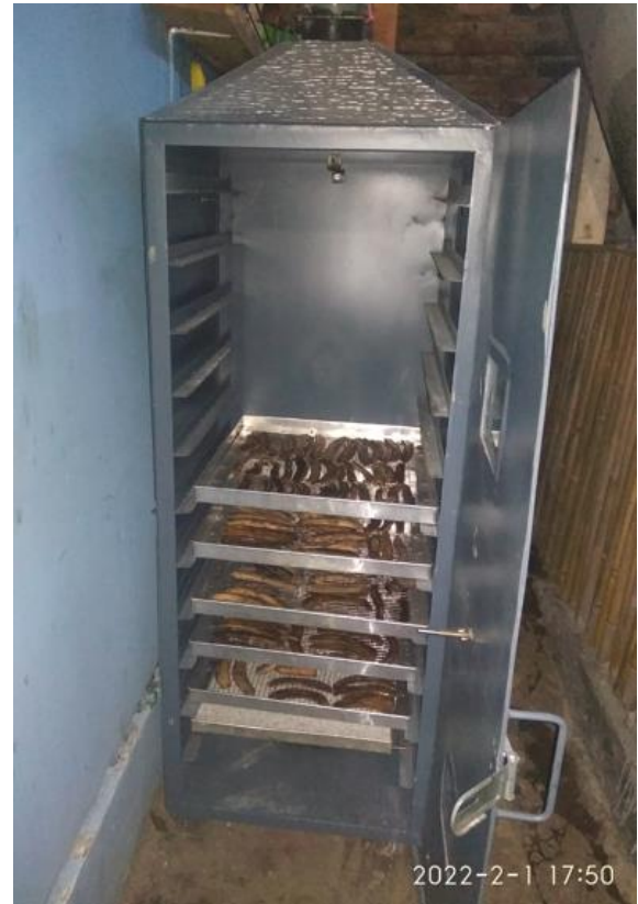
Gambar 3. Inovasi Oven dengan Pasir Zeolit dan pemanas dual ramah lingkungan
