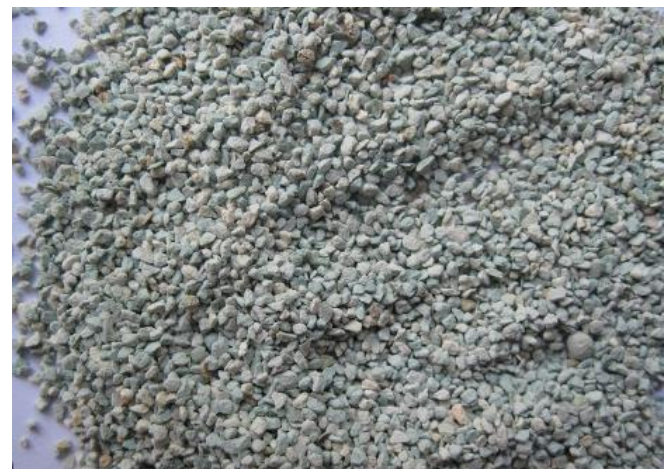
Gambar 4. Inovasi Pasir Zeolit yang diletakkan di dasar Oven dengan pemanas dual ramah lingkungan
