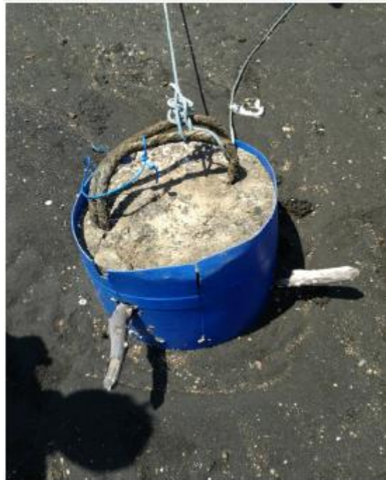
Gambar Z3 Model jangkar/ pemberat untuk mooring KJA
