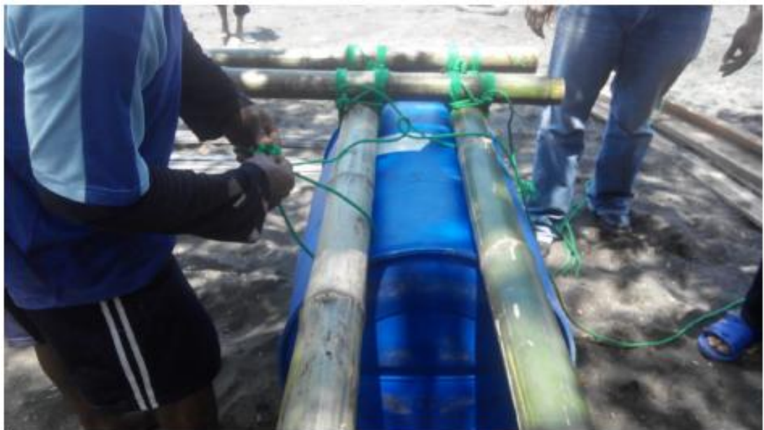
Gambar P Pengikatan rangka atas dengan pengapung/Floater
